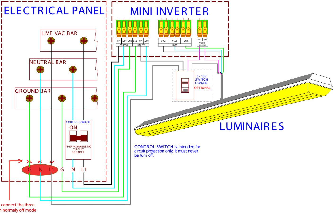
Method 2, using same circuit / Méthode 2, en utilisant le même circuit
